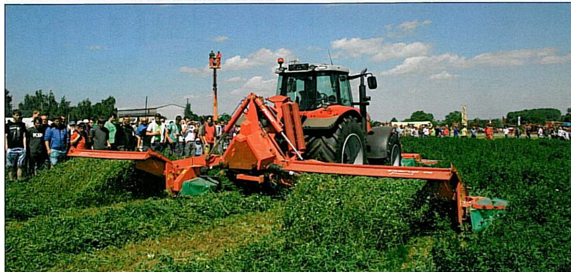
Vlajkovou lodí společnosti Kverneland je žací kombinace čelně nesené diskové žací lišty Kverneland Taarup 3532 FT a dvou bočně nesených lišt Kverneland Taarup 5090
