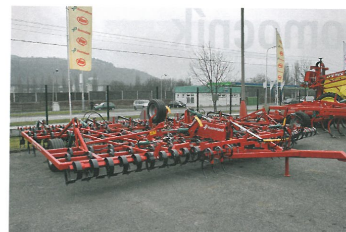
Tažený kultivátor Master 700H pro předseťovou přípravu půdy
