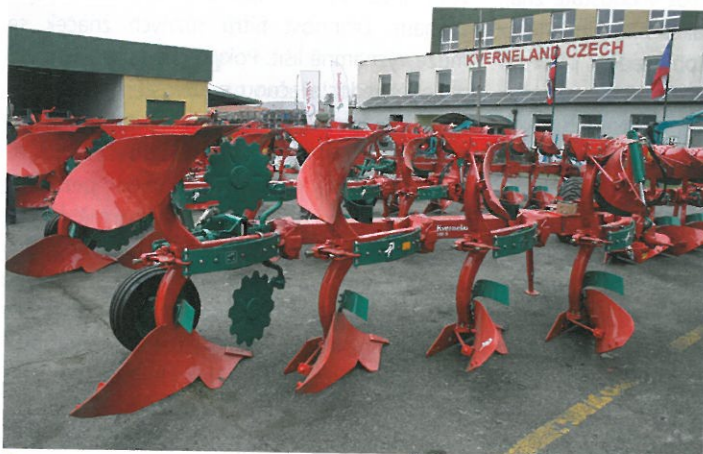
Největší zájem v roce 2011 byl o pluhy, určené za traktory s výkonem okolo 150 koní. Typickým zástupcem a nejprodávanějším modelem je nedávná novinka, čtyřradličný pluh Kverneland 150 S
