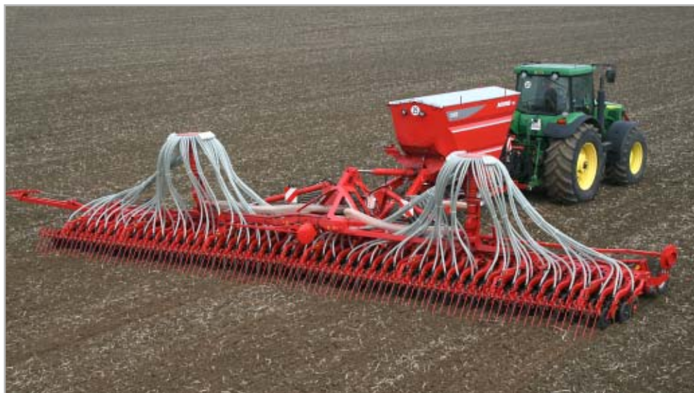
Secí stroj Accord DG – záběr až 15 m a zásobník 6000 l
