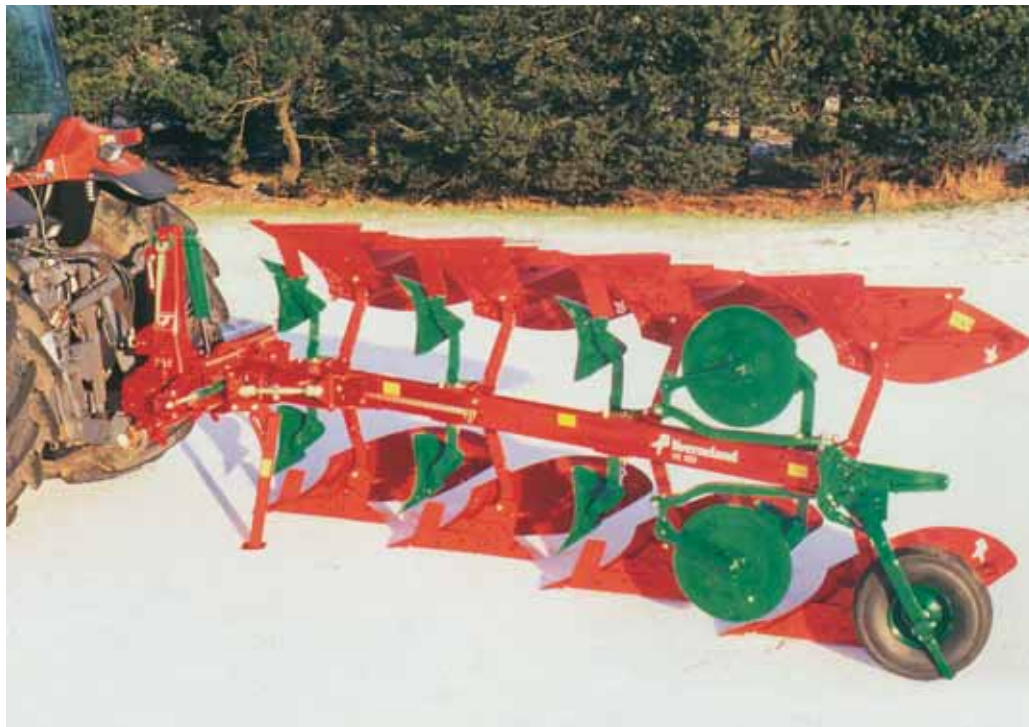
Střížné šrouby o průměru 20 mm, které chrání slupici před poškozením, se lámou až při zatížení 4500 kg.
