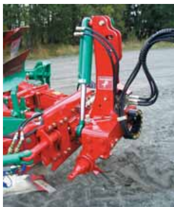
Všechny hydraulické hadice procházejí hlavním otočným čepem, aby se zabránilo jejich poškození při otáčení pluhu.
