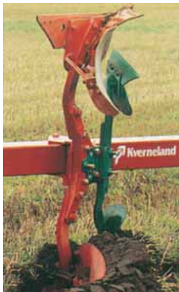
Střížné šrouby o průměru 20 mm, které chrání slupici před poškozením, se lámou až při zatížení 4500 kg.
