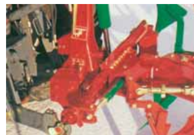
Ve standardu je mechanické nastavení záběru, ovládání hydraulické je dodáváno na přání.
