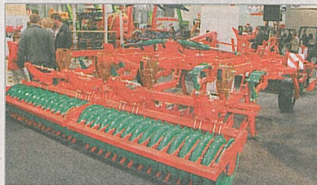
Radličkový podmiřič a hloubkový kypřič Kverneland CLC Pro lze využít k podrývání, podmiřce i přípravě půdy před setím Foto Vladislav Fuka
