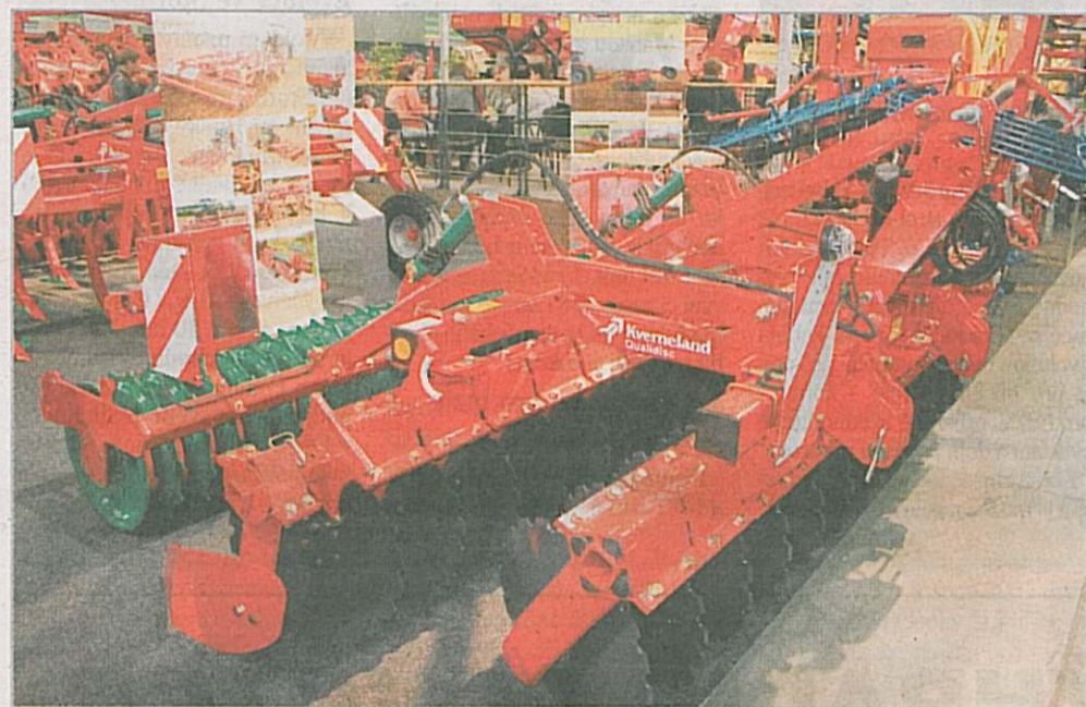
Talířový podmiřič Kverneland Qualidisc je vhodný k mělkému zpracování půdy do hloubky 15 cm Foto Vladislav Fuka
