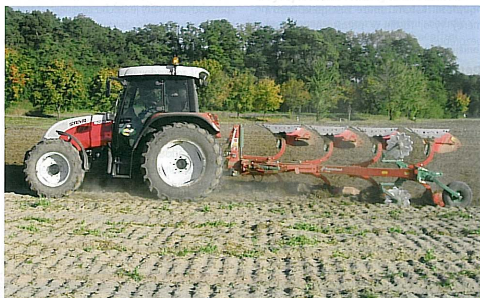
Pluh Kverneland 150B utáhne i traktor o výkonu 100 koní
