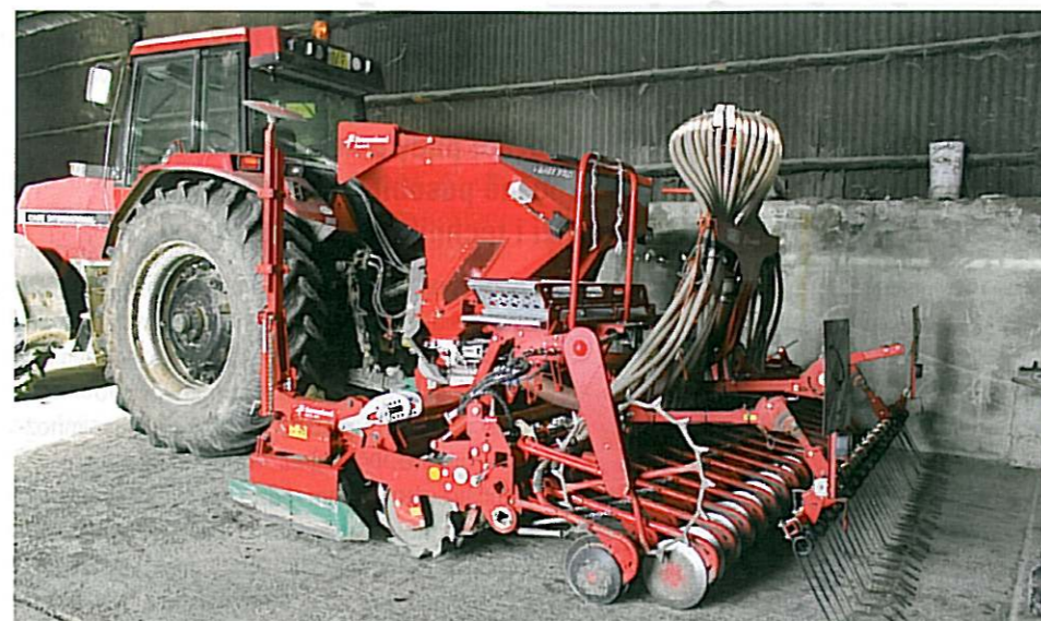
Secí stroj Kverneland Accord I-drill v podniku Bylanka Chrášťany má na každém semenovodu instalovaný průtokoměr, takže obsluha stroje ihned může identifikovat problém
