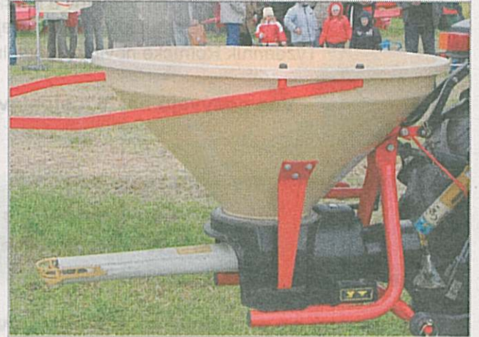
Hubicové rozmetadlo Vicon PS s násypkou 175 l umožňuje v sadech a vinicích hnojit do řádku Foto Vladislav Fuka
