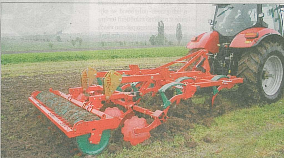
Radličkový podmiatač a hloubkový kypřič v jednom, to je nový Kverneland CLC Pro Foto Jiří Hruška
