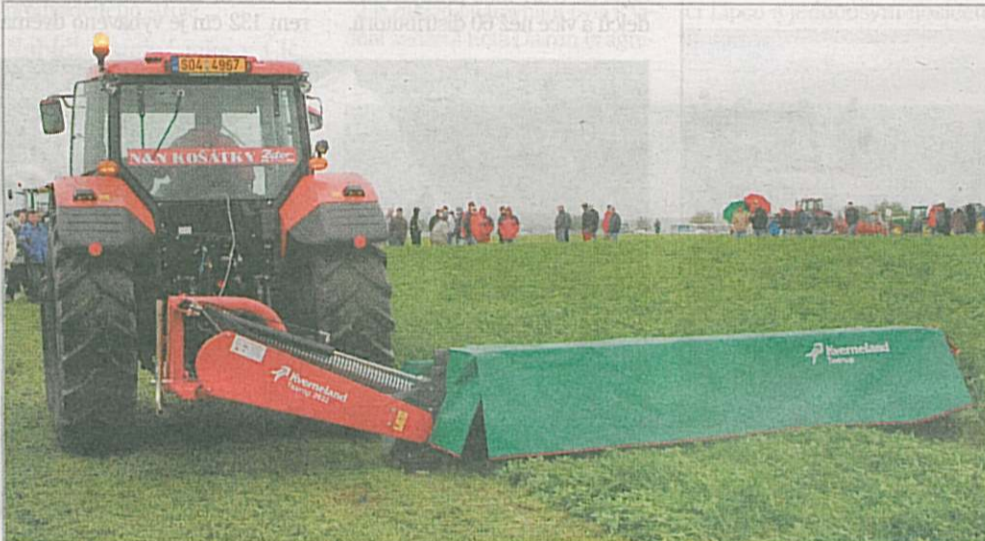
Jednoduchý diskový žací stroj Kverneland Taarup 2632 bez kondicionéru s pracovním záběrem 3,2 m Foto Vladislav Fuka
