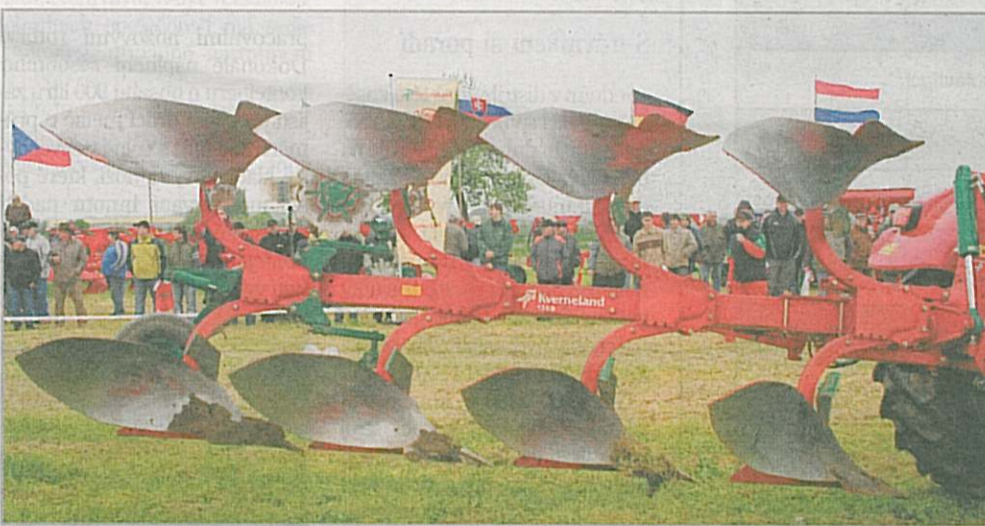
Čtyřradličný oboustranný nesený pluh Kverneland 150 B lze agregovat s traktory o výkonu do 150 koní Foto Vladislav Fuka
