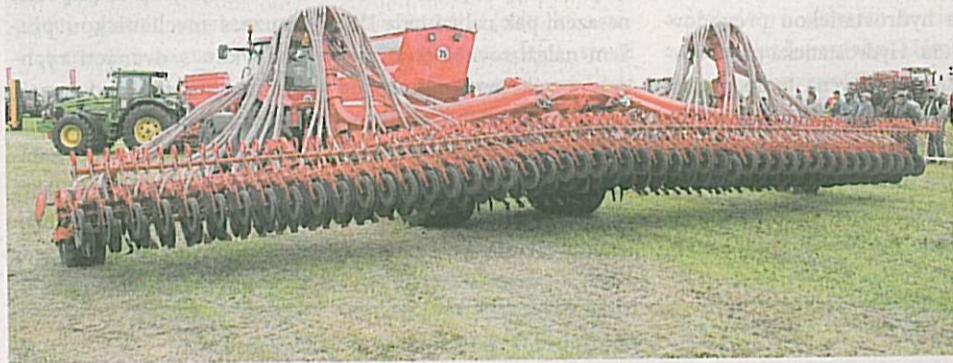
Pneumatický secí stroj Kverneland Accord DG 1200
