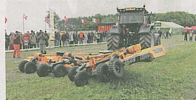
Mulčovač s vertikální osou rotace McConnell SR 620
