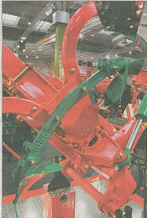
Pluh Kverneland 150 B je možné osadit novým typem předradličky (v zelené barvě), která se skládá z levého a pravého dílu a pouze z jedné slupice Foto Vladislav Fuka
